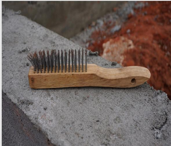
Проволочные щетки могут очистить ржавые железные детали
