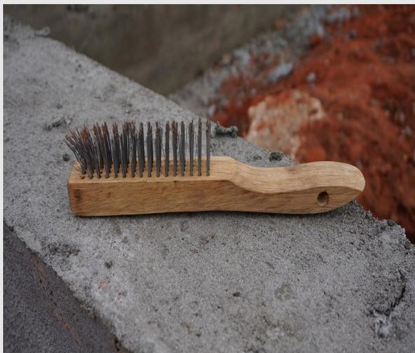
**Проволочные щетки могут очистить ржавые железные детали**
