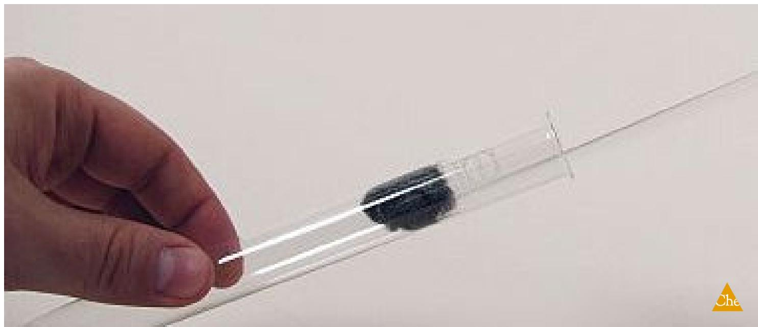
В этом эксперименте на примере "ржавой железной ваты" ясно показано, что окисление также может происходить в течение длительного времени и "незаметно". Эксперимент показывает, что железо подвергается коррозии и ржавеет при длительном нахождении во влажном воздухе.
